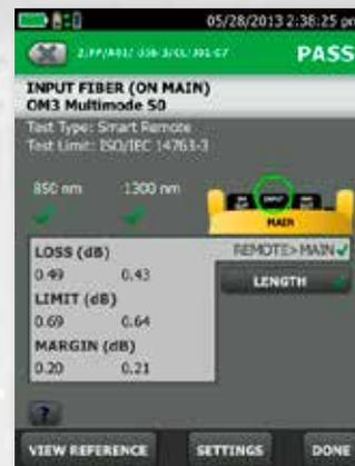
*Im Detailfenster werden die Dämpfungsreserven und die erlaubten Grenzwerte für die Glasfaser an zwei Wellenlängen angezeigt.*
