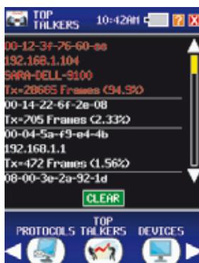
Top Talkers weist die MAC-Adresse bzw. IP-Adresse aus, Gerätenamen, Anzahl und prozentualen Anteil an den im Netzwerk übertragenen Frames, geordnet von der größten verwendeten Bandbreite bis zur kleinsten.
