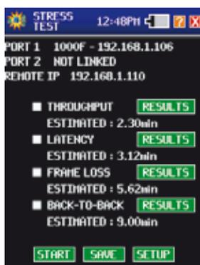
Der Stresstest erzeugt Netzwerkverkehr und misst die Leistungskennwerte entsprechend RFC 2544.
