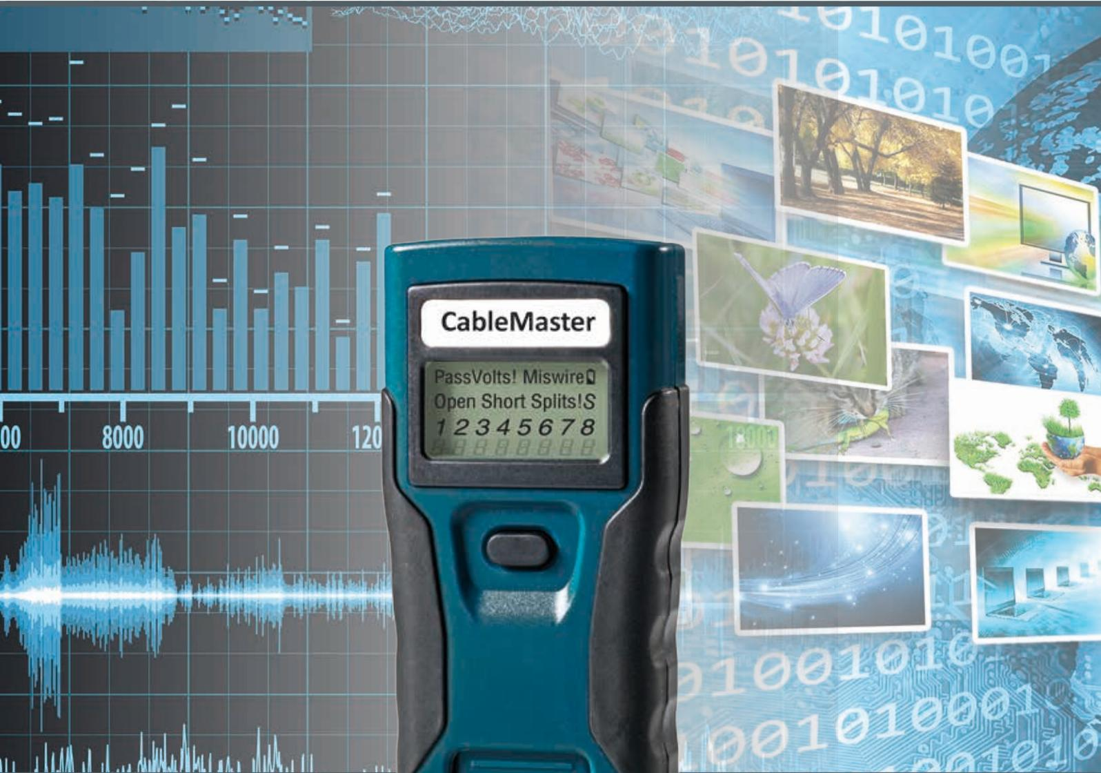
Der CableMaster 200 ist ein wirtschaftlicher, kompakter Durchgangs- und Verdrahtungstester für Ethernet-Kabel. Der ergonomische Handtester ist einfach zu bedienen. Sein großes Display zeigt direkt einfach zu verstehende Meldungen an. Er gehört zur Grundausstattung eines jeden Installateurs.
