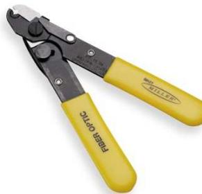
Das Standardwerkzeug zum Abmanteln von 250  $\mu$ m Fasern.
